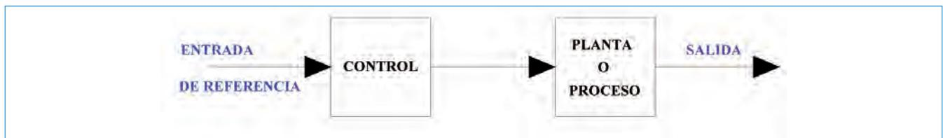
Figura 2.3: Diagrama de bloques de un sistema de control
